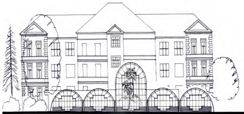
▲ Kresba nových skleníků od architekta Petra Kalandy. Skleníky přiléhají k provozní budově, na níž je pochozí střešní zahrada
